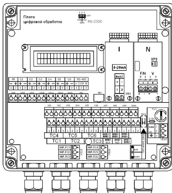
В теплосчётчиках **ТЭМ-106-1, ТЭСМА-106-1** возможно подключение **7 датчиков температур, 4-х датчиков давления** и **6 датчиков расхода**. Подключение преобразователя параметр/ток или преобразователей параметр/число импульсов возможно при заказе дополнительно модулей тока и/или модулей импульсов. Модули тока преобразуют расход, температуру в ток 4-20 мА. Модули импульсов преобразуют приращение энергии, приращение массы, приращение объема в число импульсов.
